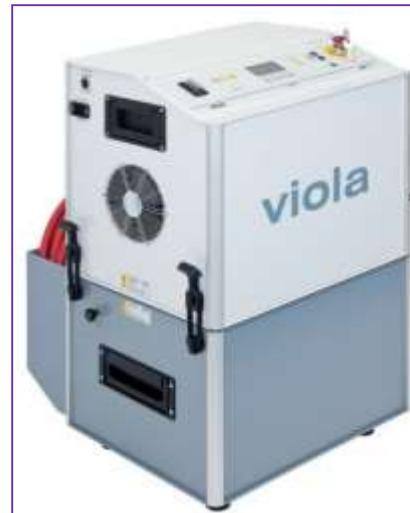
**VIOLA TD** - 35 kV-a qədər güc kabellərin diaqnostikası, tangens deltanın ölçülməsi, VLF və DC sınağı üçün istifadə olunur.
