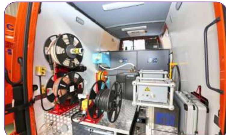
Baur firmasının 2 ədəd kabel sınaq avtolaboratoriyası da Laboratoriya Mərkəzində yer almaqdadır. Bu avtolaboratoriyanın avadanlıqları texniki xarakteristikalarının üstün olmasına görə dönyanın inkişaf etmiş ölkələrində geniş istifadə olunur.
